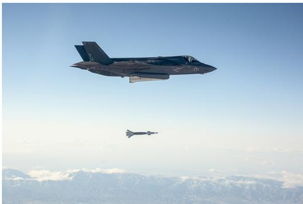
Foto 2. Test d'impiego di una bomba a guida laser Paveway II (GBU-12) da parte di un F-35.
