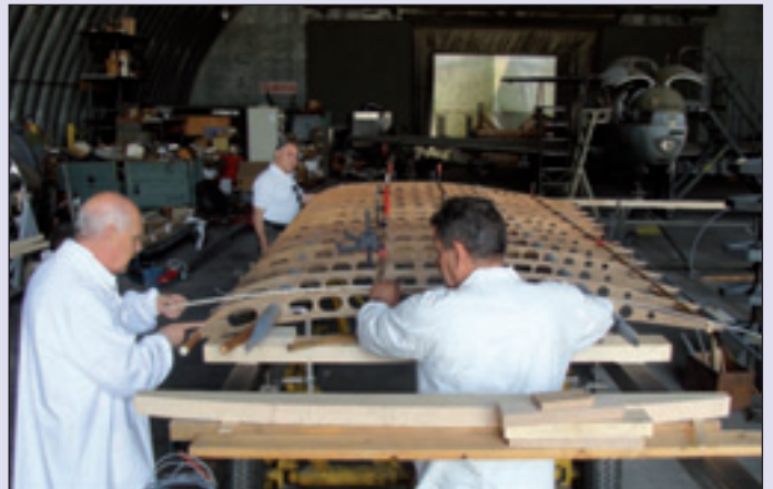
Cameri, maggio 2009: assemblaggio semiala destra.
